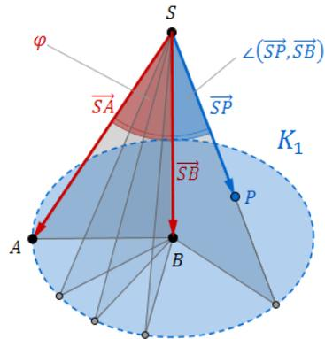
Die Mantellinien (Verbindungsstrecken zwischen Basiskreispunkte und Spitze) bilden zusammen mit der Drehachse (Höhe) einen Winkel  $\varphi$ , der sogenannte „halbe Eröffnungswinkel“.
