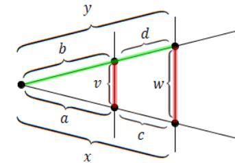
Wird ein Strahl von zwei parallelen Geraden geschnitten, dann gelten folgende Beziehungen (zwischen den Strecken):
