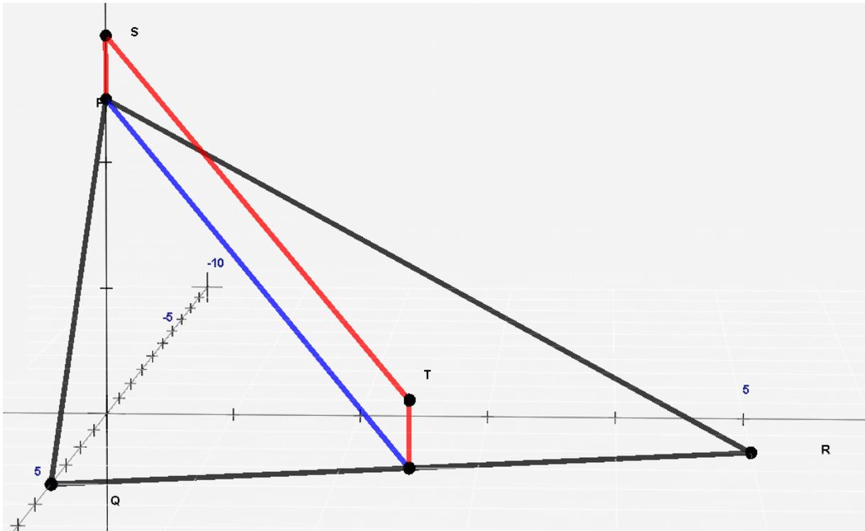
Die rote Strecke zeigt den Verlauf der Zahnradschiene ( im Vergleich zur Ebene überhöht gezeichnet ). Die Pfosten haben in der Realität eine Höhe von 0,5 m. Die Bahnlinie verläuft geradlinig und parallel zur Hangfläche. Daraus ergeben sich die Punkte  $S$  und  $T$  zu
